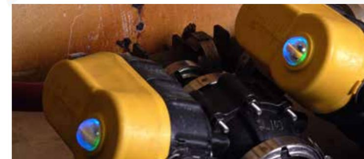
LED's entregam resposta de desempenho das válvulas indicando azul para energia e amarelo para condição de fusível queimado. Com a verificação opcional de aberto / fechado, o LED indica verde e vermelho, respectivamente. Como uma opção adicional, as EVX reportam temperatura, voltagem e contagem de ciclos.
